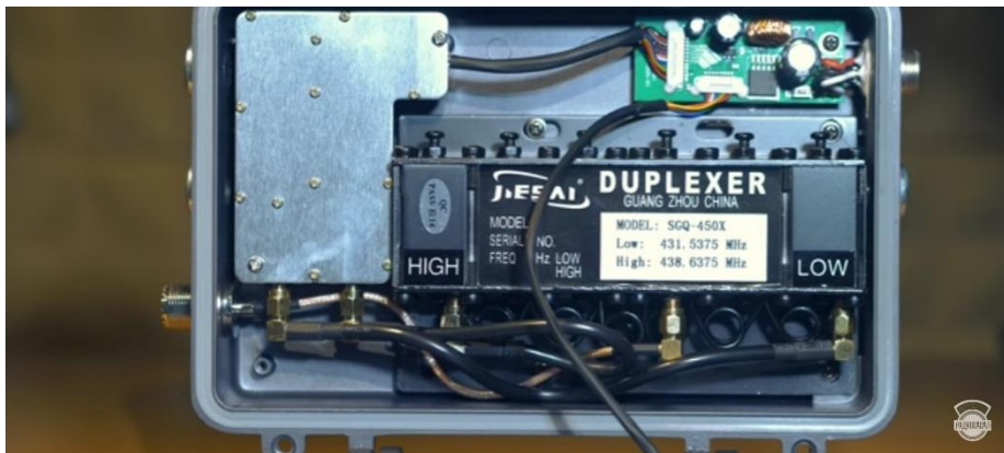
Рисунок 31 – Дуплексер встроенный в ретранслятор «КОМБАТ ТРАНС-12» (Chierda/Retevis), с разносом частот 7,1 МГц (с) А.Игонин
