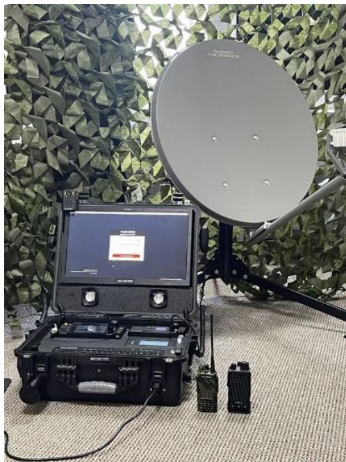
Рисунок 57 - Combat Starnet с VSAT-терминалом (комплектация Combat Starnet Sky) для подключения к сетям общего пользования (Интернет)
