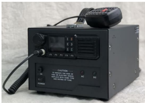
Рисунок 20 – Радиостанция «КОМБАТ ТРАНС-4000 БАЗА» (Belfone/Lira) с внешним блоком питания в общем корпусе
