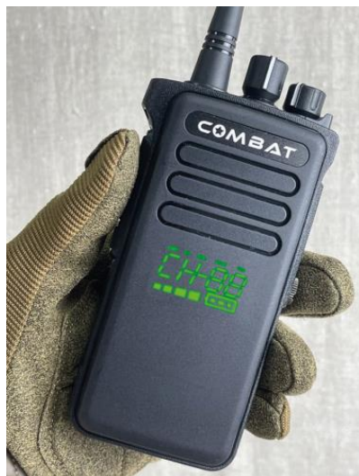
Рисунок 14 – Индикаторы ТАКТИК ПРО С позволяют контролировать основные параметры РСТ, что улучшает контроль режимов работы устройства
