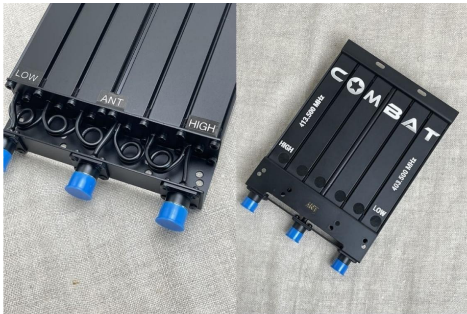
Рисунок 32 – Дуплексер UHF 403,500 - 413,500 МГц с разнесом 10 МГц
