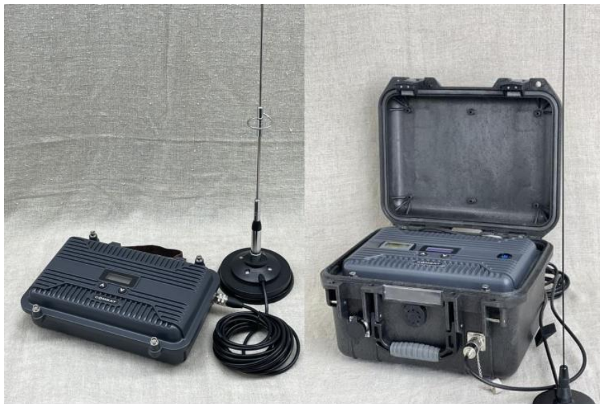
Рисунок 25 – Ретранслятор «КОМБАТ ТРАНС-12» (Chierda/Retevis) со встроенным дуплексером
