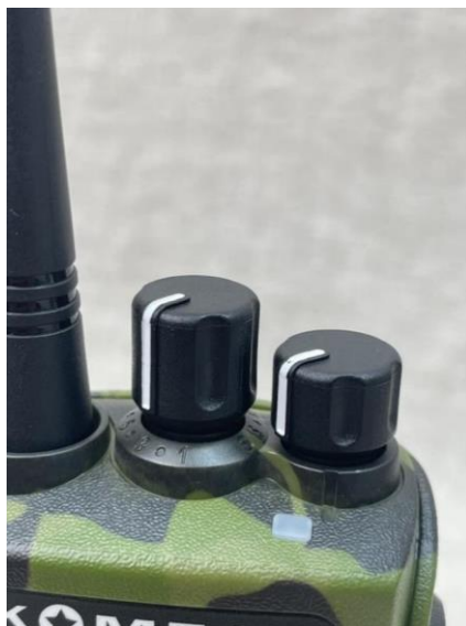
Рисунок 50 – Механический переключатель каналов (расположен сверху корпуса, в центре)
