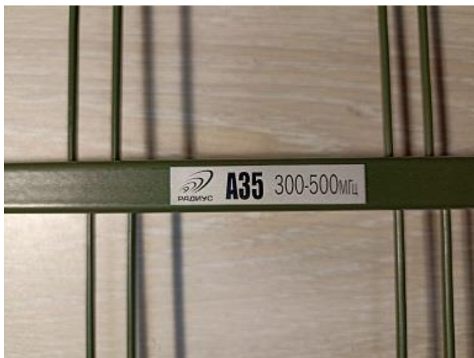
Рисунок 67 – Маркировка направленной антенны, частотный диапазон должен соответствовать используемому
