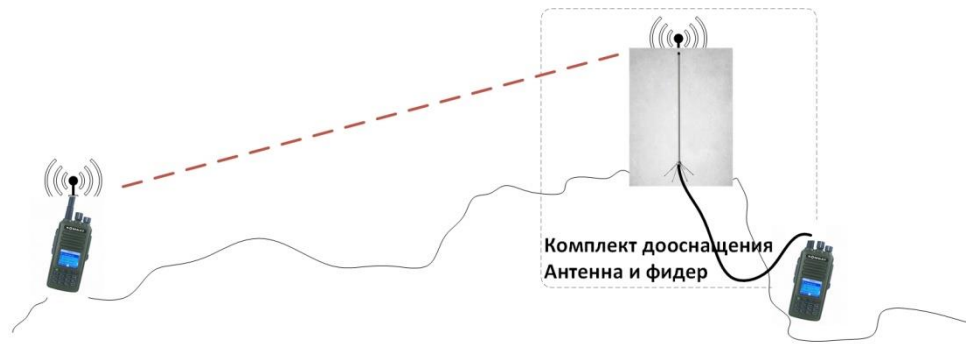
Рисунок 15 – Использование комплекта дооснащения (2+) РСТ для повышения качества связи
