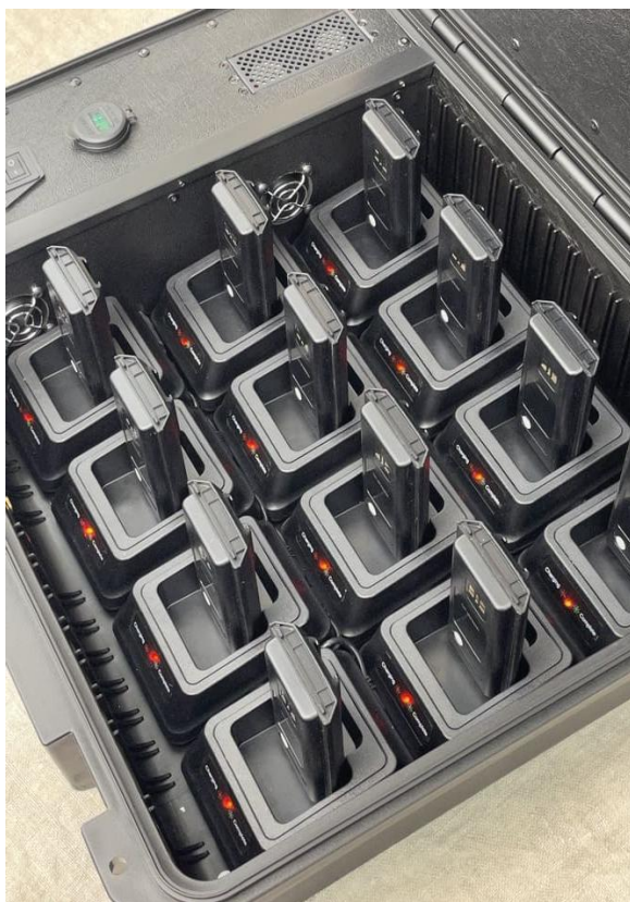
Рисунок 58 – Многоместное зарядное устройство КОМБАТ МЗУ-12 (мобильный кейс) для зарядки 12 РСТ
