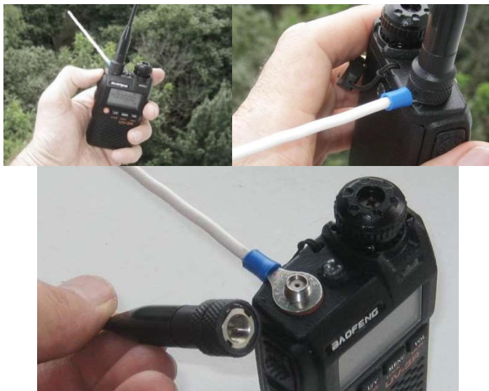
Рисунок 60 – Пример установки противовеса, используемого для повышения дальности радиосвязи 11
