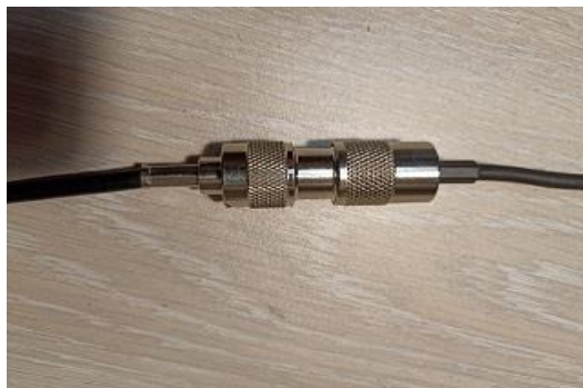
Рисунок 68 – Подключение радиочастотного кабеля антенны к фидерной линии
