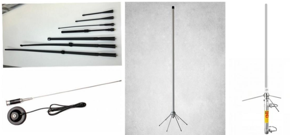
Рисунок 37 – На рисунке представлены несимметричные антенны радиостанций для различных диапазонов, автомобильная и две (2) базовые антенны
