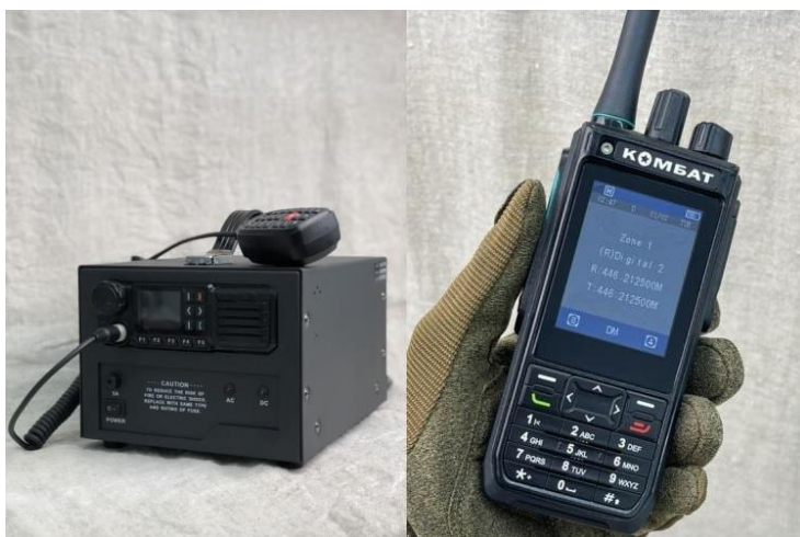
Рисунок 23 – Радиостанция "КОМБАТ ТРАНС-4000 БАЗА" и "ТАКТИК ТРАНС-6" работающие в SFR режиме
