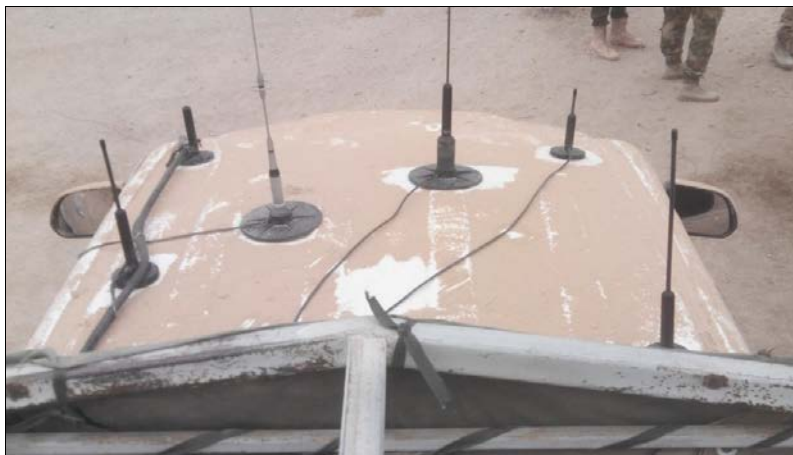
Рис. 12. Размещение станции помех «Лесочек» на капоте автомобиля
