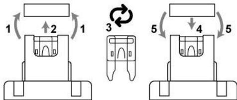
Держатель предохранителя для удобства выведен на внутреннюю поверхность кейса. Если предохранитель перегорает, то радиостанция прекращает функционировать. Определите источник проблемы и замените вышедший из строя предохранитель
