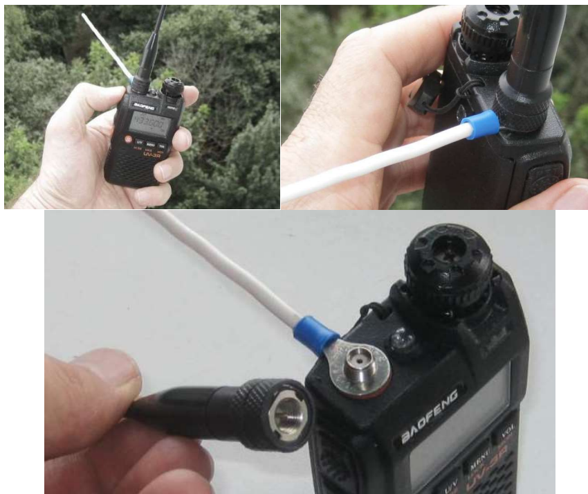
Рис. 20 – Рации с противовесом антенны (белый провод).
